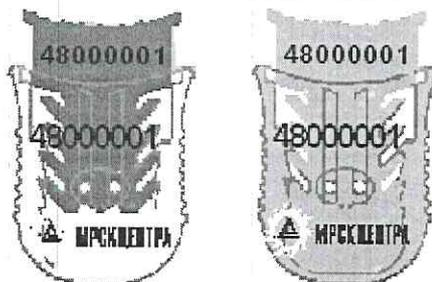
КПП типа защелка («ласточкин хвост») – должна иметь не менее 4-х пар независимых якорей по обеим сторонам. Каждый из запирающих якорей независимо от остальных запирающих элементов удерживает замковую часть в корпусе КПП.
