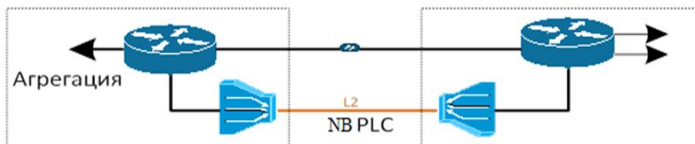
Рисунок 9. Участок сети с использованием PLC
